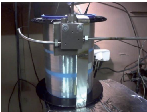
Рис. 4 Испытания демонстратора аккумулятора газа из капилляров на установке высокого давления, максимально достижимое давление газа 3000 атм
